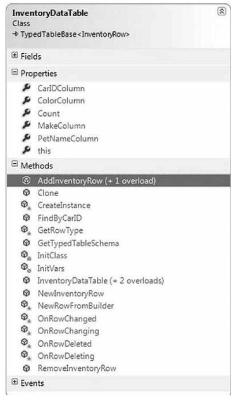
Рис. А.22. Строго типизированный класс DataTable, вложенный в строго типизированный класс DataSet
