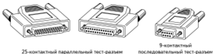
Рис. 24.6. Внешний вид типичных 9- и 25-контактных тест-разъемов
