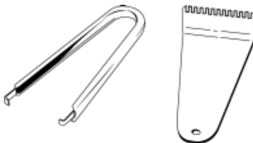
Рис. 24.2. Приспособления для извлечения из гнезд микросхем (слева) и процессоров, кроме ZIF (справа)
